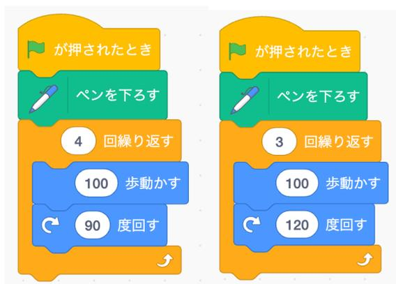
図1 正方形を作図するプログラム（左）と正三角形を作図するプログラム（右）
